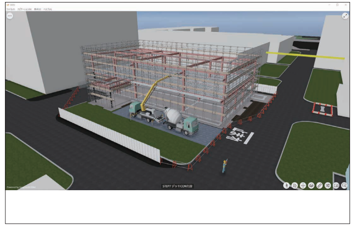
二階コンクリート打設
