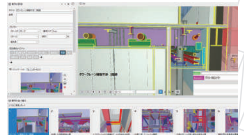
仮設補強鉄骨と空調ダクトの干渉確認状況
