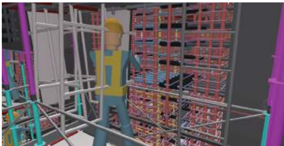
梁下端筋接続作業イメージ (安全と作業性の検討中)
