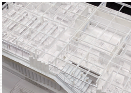
ArchicadのBIMモデルを基に、パーツを3Dプリントで出力した1/50スケールの模型
