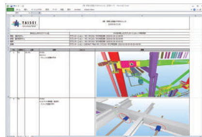
Excelファイルとして自動的に作成された画像付き干渉チェックレポート
