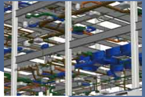
現場監理における設備機器の躯体干渉チェック
