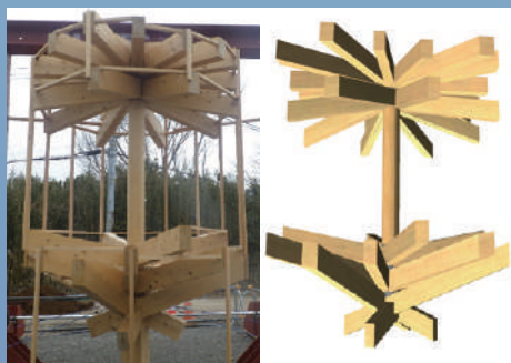
3Dモデルとサンプルによる柱の検討(日本平夢テラス) ©2018 木内建設
