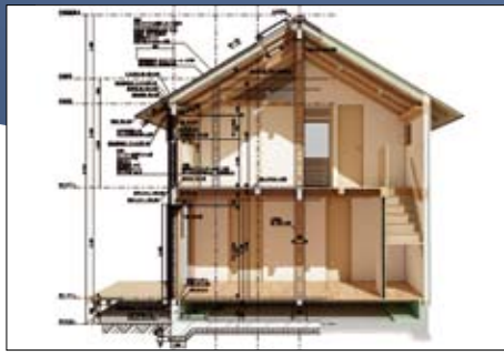
「加子母子屋」断面パース図面
