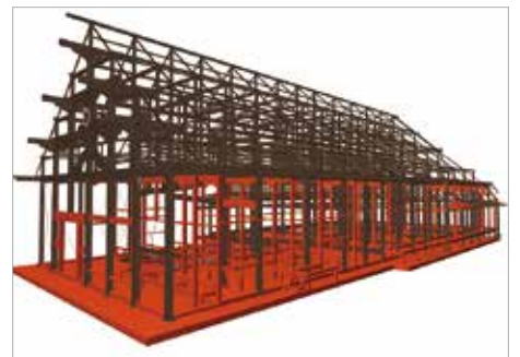
「立正寺」軸組(新設表示)
