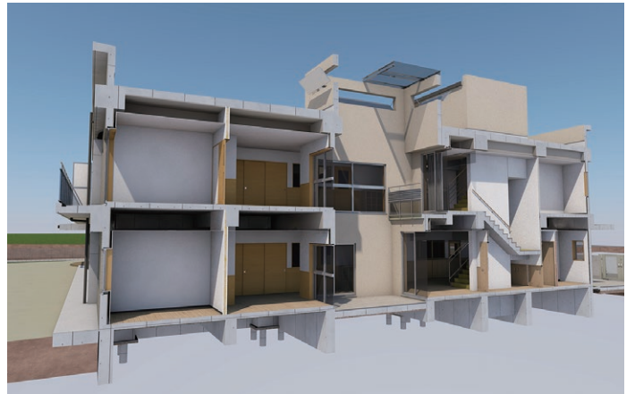
ARCHICAD で作成した「蛭雪学園」新園舎断面
